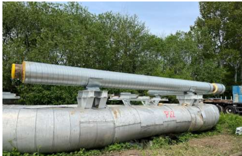
Podzemný HDP: DN300 – 2 276 m
