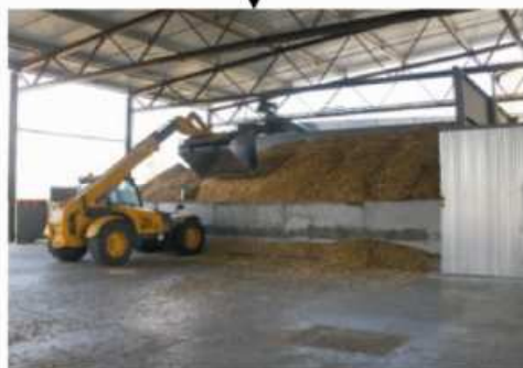
Doprava paliva do operatívnej skládky
