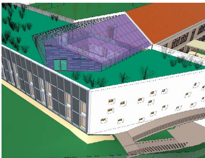
Obrázok 2: Pohľad na presklenie bazénu s navrhovaným využitím plôch na inštaláciu FV systému
